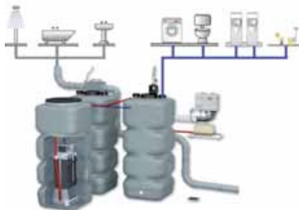
Abbildung 2: Allgemeines Fließschema einer GEP-Grauwassernutzungsanlage. Das Grauwasser wird erfasst (grau), aufbereitet und als Betriebswasser (blau) wieder verwendet.
