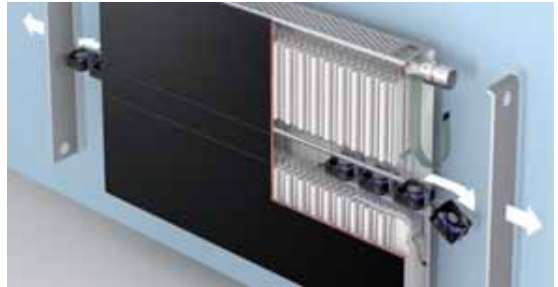
Die intelligente Steuerung wechselt zwischen statischem sowie dynamischem Betrieb und sorgt mit 6 Lüftern für bedarfsorientierte Konvektionsoptimierung. Die Lüfter sind zu Revisionszwecken durch Abnehmen der Seitenblenden ausziehbar.
